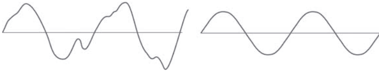
Figuur 5.1 Verskil in karakteristieken van windgolven binnen het windveld en erbuiten in een stiltegebied, als deining is ontstaan.
