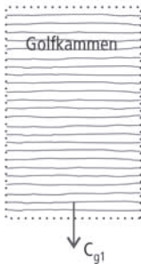
Figuur 5.3 Schematisch bovenaanzicht op de oceaan, waar een storm binnen zijn invloedsgebied windgolven genereert. De golven bestaan uit een breed bereik aan perioden. Afhankelijk van de periodetijd beweegt een groep golven met een eigen snelheid van het ontstaansgebied af.
